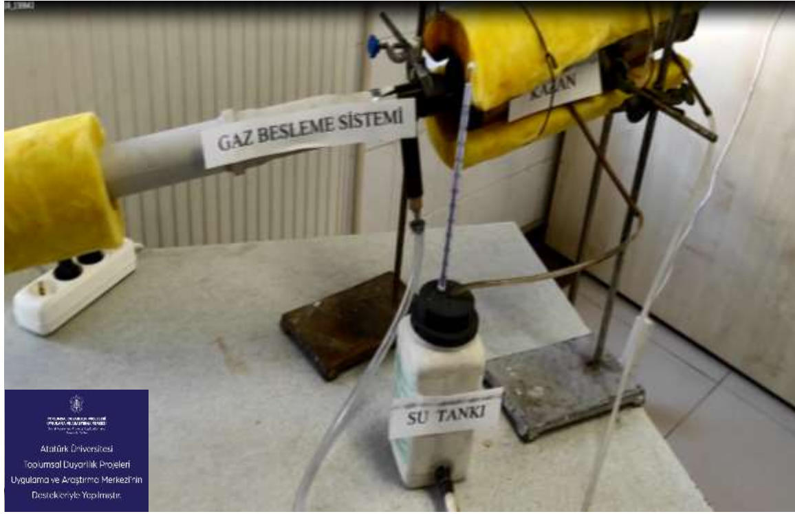
Şekil 8. Gaz besleme sistemi ve LPG tank ile olan hortum bağlantısı.
