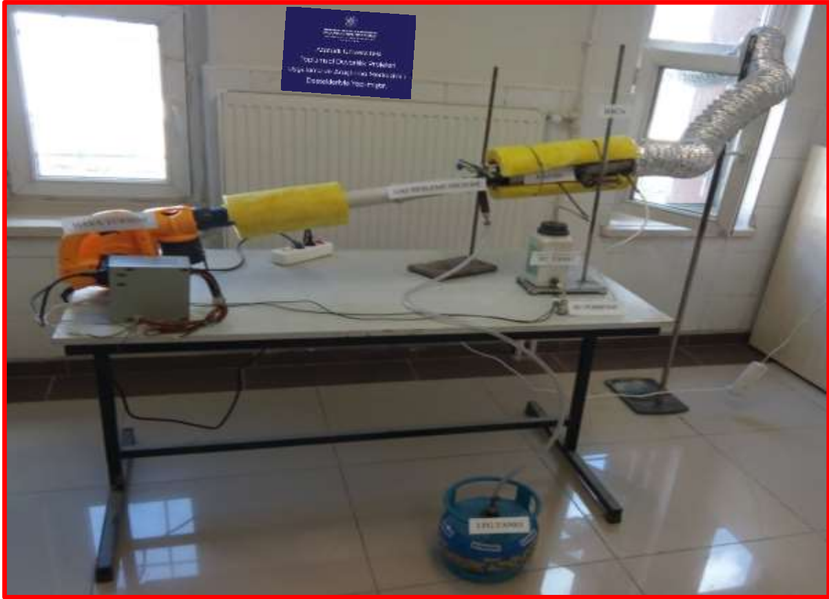
Şekil 2. Deneysel Sistem: Hava türbini, Gaz Besleme sistemi, Kazan, Su tankı, Su pompası, LPG tankı, Alüminyum baca borusu
