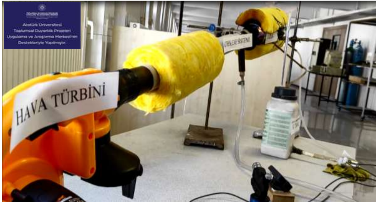
Şekil 7. Kazan içine hava besleme sistemi (hava türbini).
