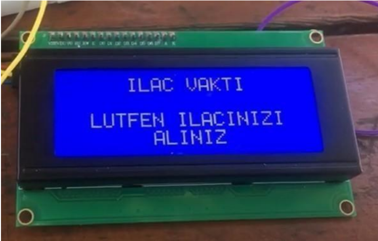
ŞEKİL 8. İlaç vakti geldiğinde led yanmakta , buzzerdan ses gelmekte ve lcd ekranda hatırlatma yazısı yazmaktadır.
