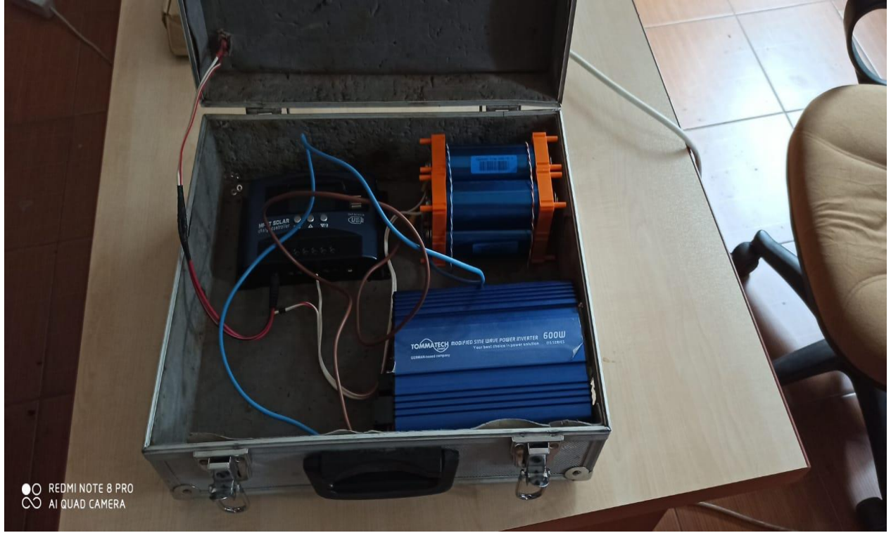
Şekil.2. Sistemimizin taşınabilir çantamıza monte işlemi
